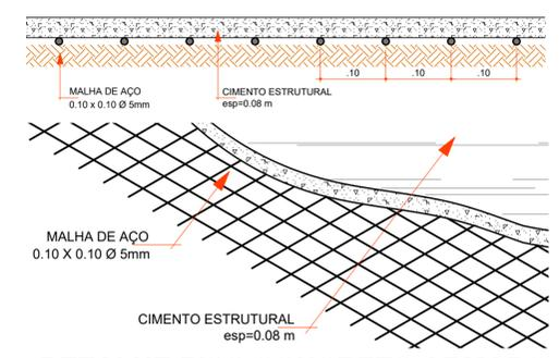
**DETALHE PISO CONCRETO ARMADO**
